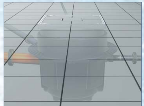
Nach komplettem Fußbodenaufbau → unsichtbare Hebeanlage
